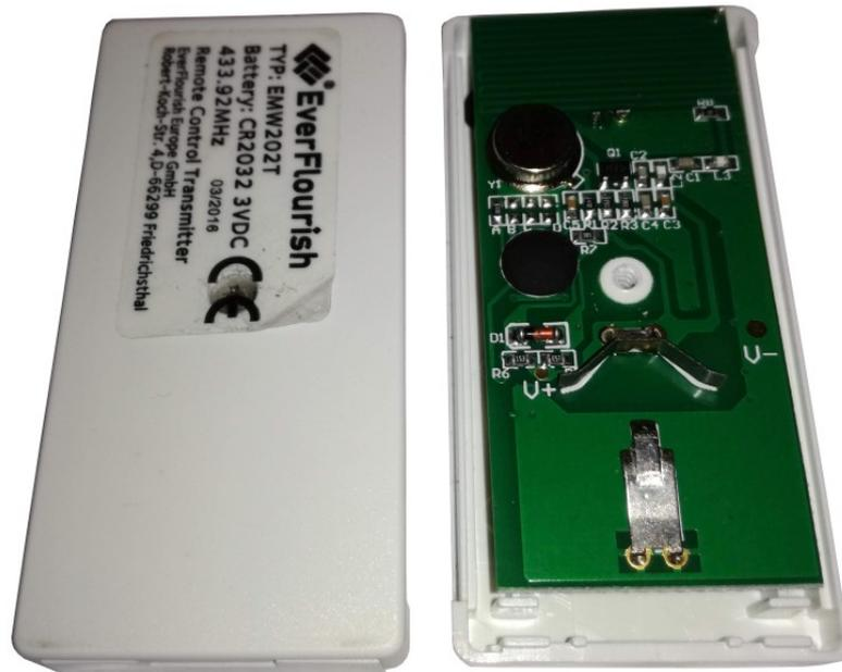
Die unten stehende Widerstandsreihe (schwarzes Bauteil mit 330 Aufschrift) bestimmt den Hauscode (die ersten 4 Ziffern des Steckdosencodes), in unserem Fall im Bild weiter unten 1000. Sollten die Widerstände anders (mehrfach) zu sehen sein, so gestaltet sich der Code entsprechend (Widerstand=1).
